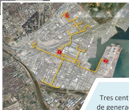
Tres centrales de generación y una red de distribución por tuberías.
